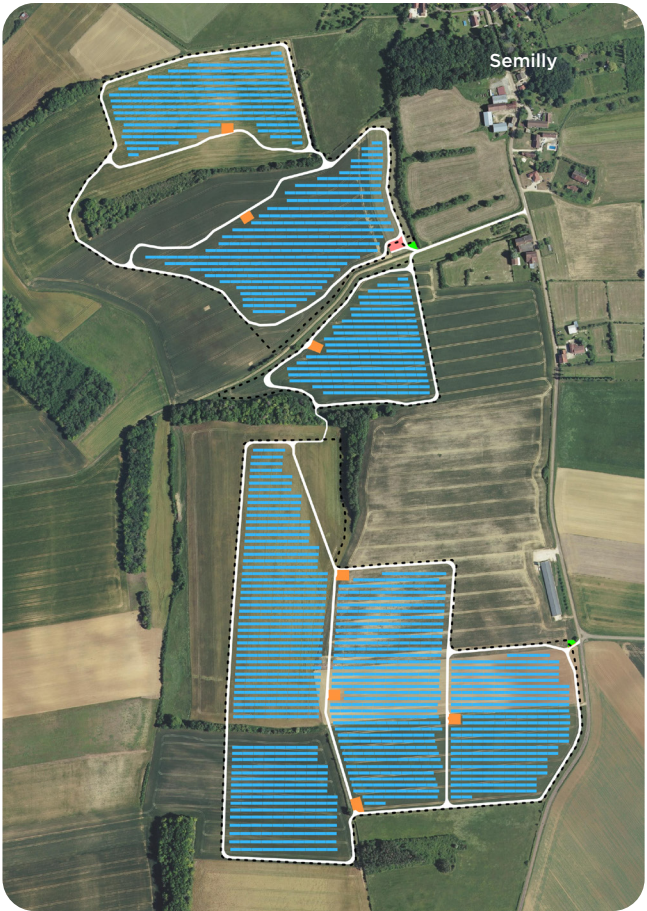
Calepinage projeté du parc agrivoltaïque
