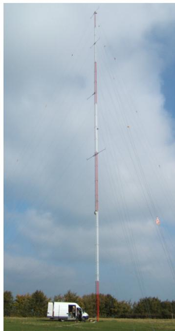
Exemple de mât de mesures installé lors du développement du parc éolien du Plateau de Savernat (03, Allier)
